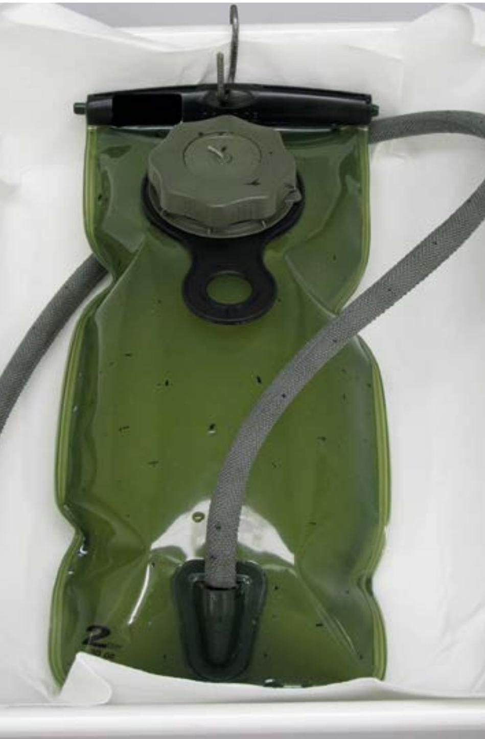
**Abbildung 2: Mit HD belegtes Trinksystem. Es besteht aus einer Trinkblase, einem Trinkschlauch und einem Maskenadapter (Hier nicht gezeigt). Geprüft werden alle Komponenten.**
