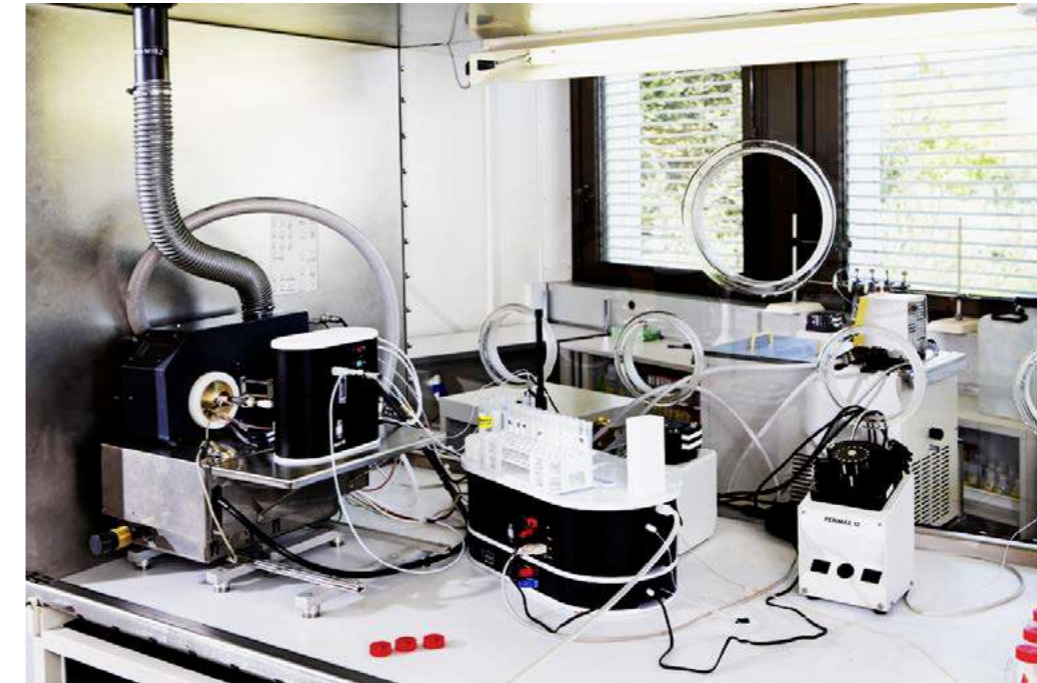
Massenspektrometrie mit induktiv gekoppeltem Plasma ICP-MS im LABOR SPIEZ. Diese Analyse-methode ermöglicht hochpräzise Isotopenanalytik.
