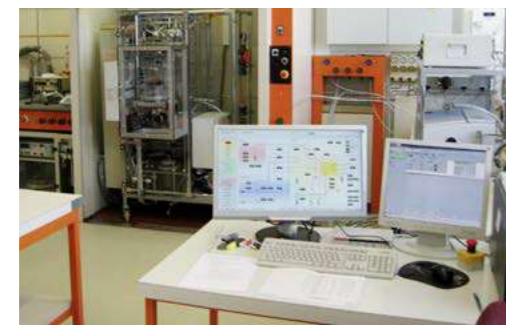
Erweiterte Prüfanlage für Atemschutzfilter
