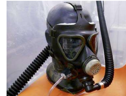
Bestimmung der Gesamtleckage einer Vollmaske
