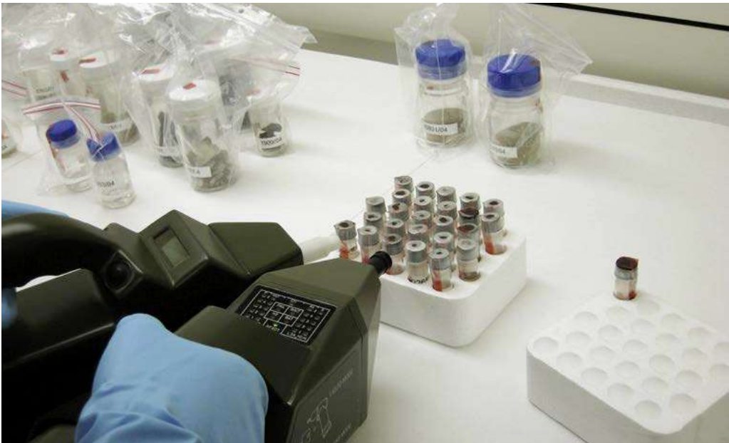
Erstes Screening der Probengefäße mittels C-Nachweisgeräten
