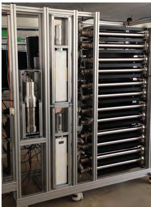
Série de détecteurs de neutrons et de rayons gamma sur le banc d'essai du constructeur.
