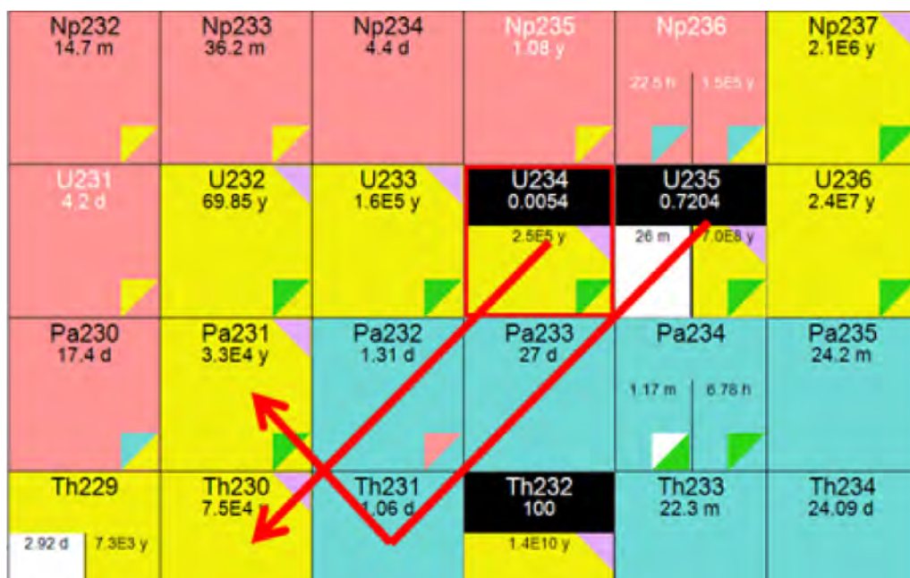
Abbildung 2: Ausschnitt aus der Karlsruher Nuklidkarte mit den zwei Zerfallswegen für die Uran- altersbestimmung.
